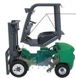
La cabina está suspendida por encima el chasis del vehículo por cuatro amortiguadores hidráulicos, lo que reduce la vibración de la
